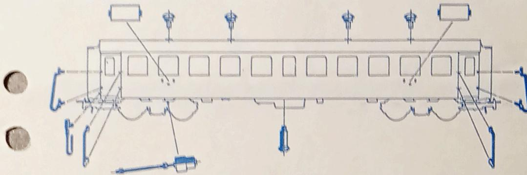
Wird der Wagen als Schlußwagen verwendet, ist einer der beiliegenden schmalen (eingezogenen) Faltenbälge zu verwenden.
