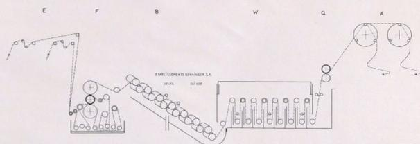
Passaggio del tessuto attraverso la macchina a mercerizzare senza catena, combinata con Foulard ad impregnare, sistema **BENNINGER**.
